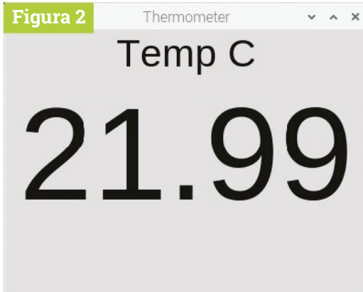
▲ Figura 2 Visualizzazione della temperatura tramite guizero
